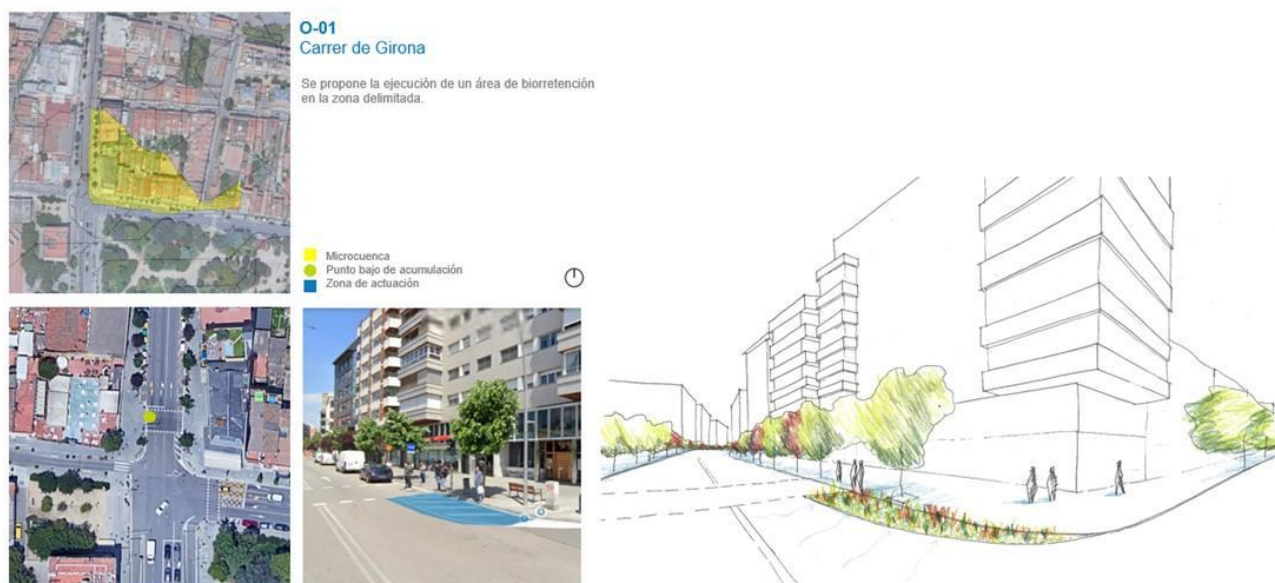
Figura 5: Propuesta de solución de drenaje sostenible de un área de biorretención. Fuente: Estudio para la mejora de la permeabilidad mediante SbN como los SUDS, para el municipio de Granollers
